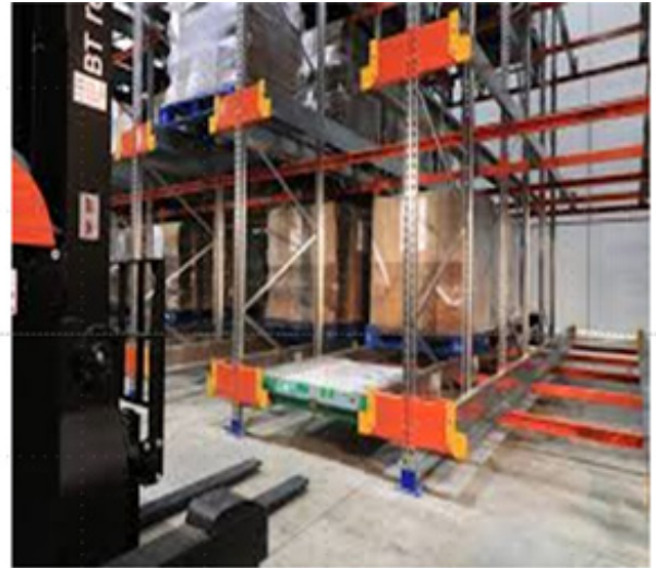
Figura 1: Sistemi di movimentazione logistica: scaffale + navetta + carrello elevatore + sistema gestionale
