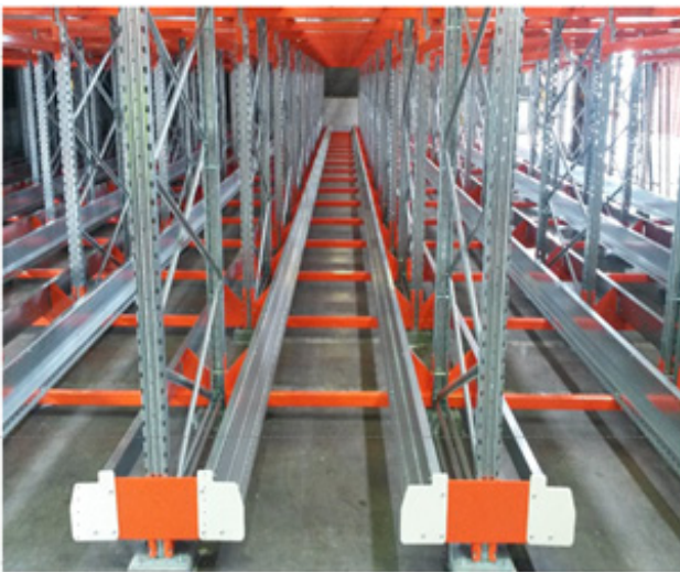
Figura 2: Sistemi di movimentazione logistica: dettaglio dello scaffale e della navetta
