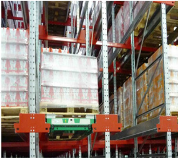
Figura 1: Sistemi di movimentazione logistica: scaffale + navetta + carrello elevatore + sistema gestionale
