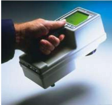
Le **coordinate cromatiche** costituiscono una modalità di misura di come l'occhio umano percepisce i colori della segnaletica quando questa è illuminata da luce diurna diffusa. Il punto definito dalle due coordinate nel diagramma di cromaticità si trova all'interno dei box cromatici definiti per il colore bianco e per il colore giallo (giallo permanente e giallo temporaneo) previsti nella UNI EN 1436 . In pratica:
