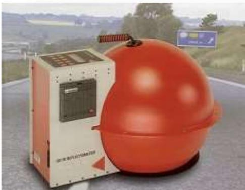
La visibilità diurna della segnaletica stradale è misurata tramite i parametri fotometrici denominati rispettivamente “**Coefficiente di luminanza in condizioni di illuminazione diffusa**” indicato con “ $Q_d$ ” [ $\text{mcd}\cdot\text{m}^{-2}\cdot\text{lux}^{-1}$ ] e “**Fattore di luminanza**” indicato con “ $\beta$ ” (con
